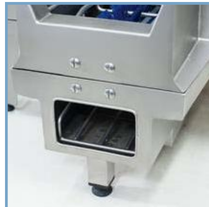
Einfache Reinigung des Oberschuhs Easy cleaning of the upper shoe
